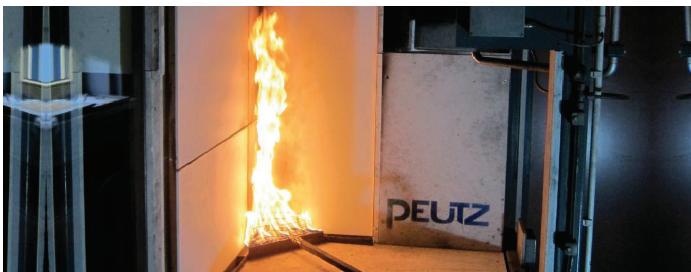
SBI test za ponašanje u požaru @ Peutz laboratorij za sigurnost od požara
